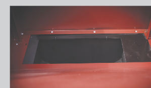
prostrani bunker omogućuje autonomiju u radu kotla
