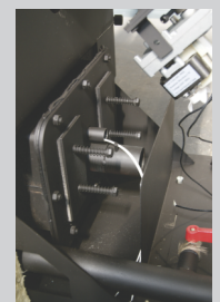
mehanizam za zaštitu kotla od povećanja pritiska u ložištu
